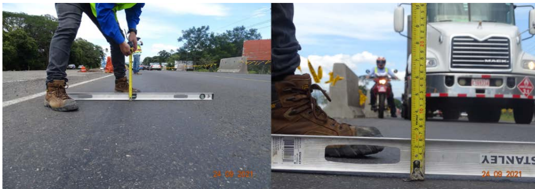
Figura 40. Deformación en capa de rueda. Fecha: 24 de setiembre del 2021
