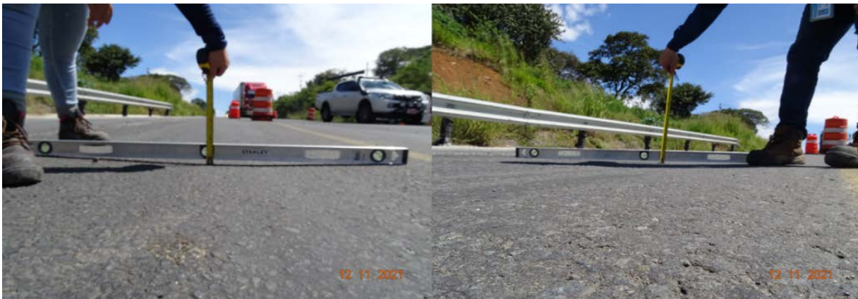
Figura 43. Deformación de 2 cm en Est. 26+700. Fecha: 12 de noviembre del 2021
