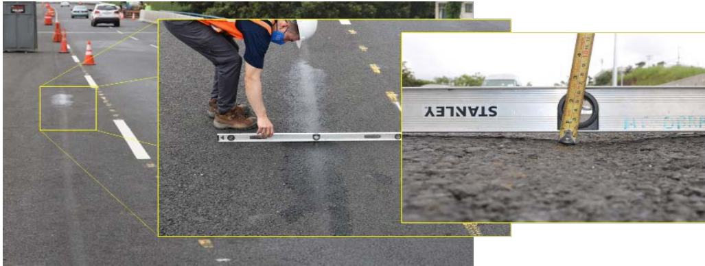
Figura 56. Diferencias de nivel en junta longitudinal puente sobre el río Segundo. Fecha: 26 de agosto del 2021
