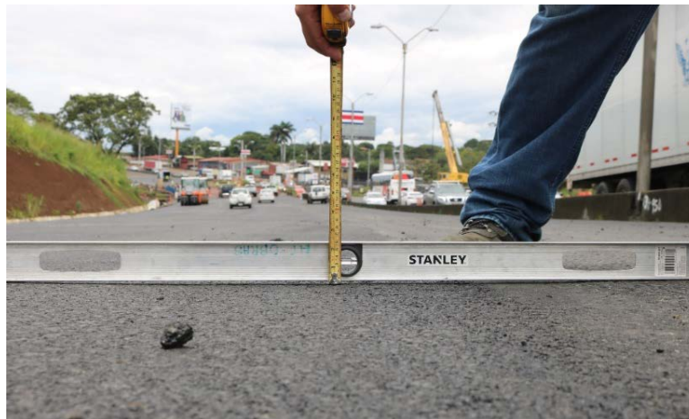
Figura 56. Diferencias de nivel en junta longitudinal puente sobre el río Segundo. Fecha: 26 de agosto del 2021
