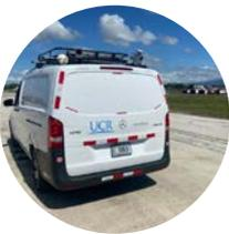
Mediante el Imaging, un vehículo equipado con dos cámaras fotográficas de alta resolución que permite levantar inventarios de las pistas, o realizar un levantamiento georreferenciado.
