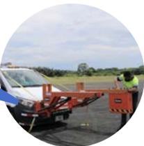
Conocido por sus siglas en inglés como GPR, el Georadar de Penetración es un ensayo no destructivo que cuenta con 2 antenas de frecuencias (1 GHz y 2 GHz), se utiliza para registrar y estimar los espesores de la estructura del pavimento.
