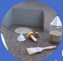
Es un método de ensayo que permite determinar la profundidad promedio de la macrotextura de la superficie del pavimento con el propósito de contribuir a la determinación de la capacidad de agarre con el pavimento.
