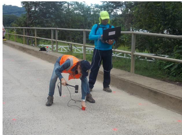
**Figura 6. Ensayo de impacto-eco (método sónico) en puente sobre el río Seco en ruta cantonal, cantón de Garabito.**
