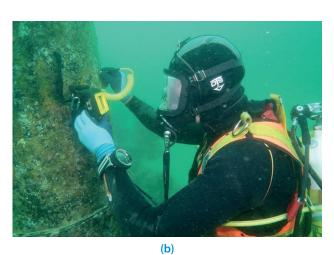
Figura 5. (a) Métodos de ensayos no destructivos para puentes con elementos de concreto (LanammeUCR, 2015); (b) Inspección bajo el agua de la subestructura de un puente (Southern Divers Australia, 2019)
