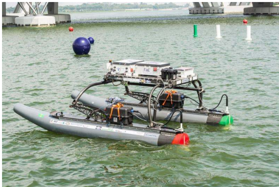
Figura 3. Vehículo marino no tripulado para realizar inspecciones de puentes, desarrollado por medio de una investigación a cargo de la Universidad del Atlántico de Florida. Fuente: Florida Atlantic University, 2015.
