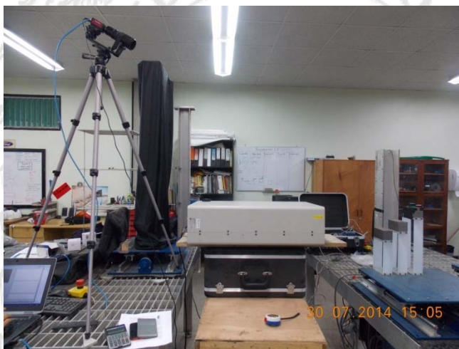
Figura 25. Alineación sesgada de la cámara respecto al plano de movimiento del blanco
