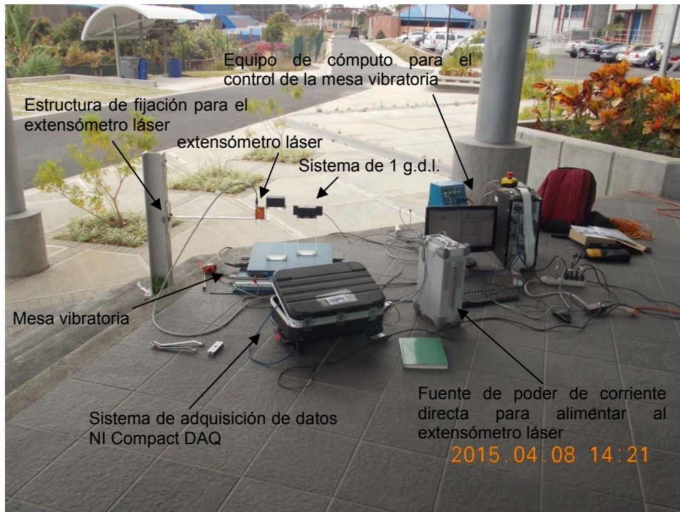
Figura 45. Instalación de los equipos para la prueba de validación.
