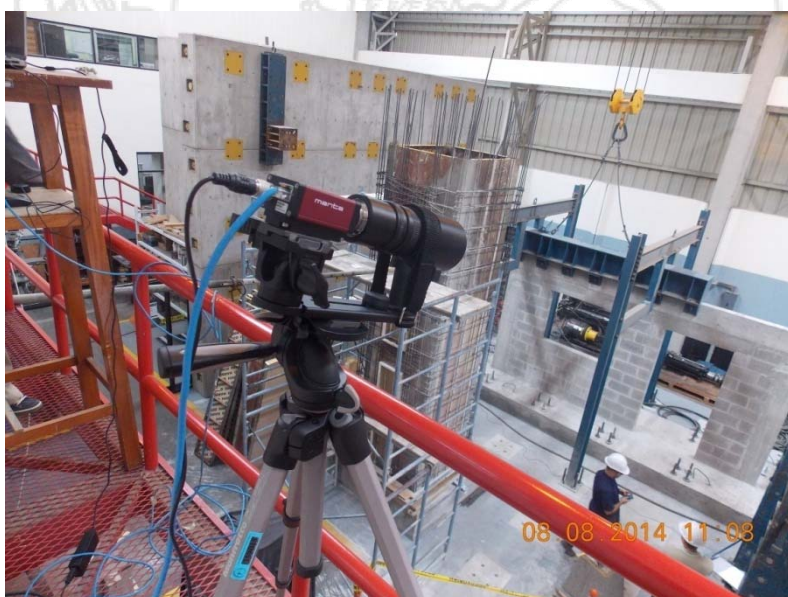
Figura 67. Ubicación de la cámara durante la prueba del muro de mampostería.
