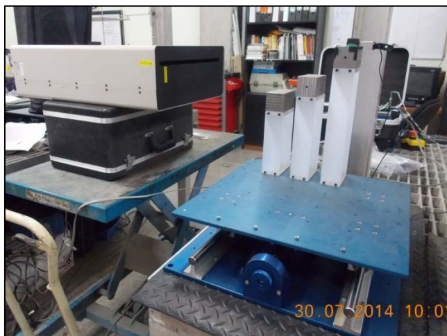
Figura 19. El extensómetro láser y la mesa vibratoria utilizada para la validación del sistema en laboratorio.
