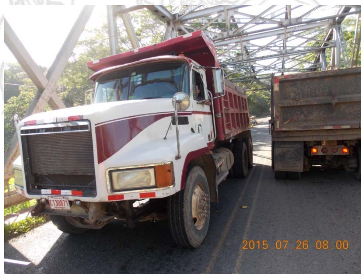
Figura 94. Ubicación de los camiones para producir máxima deformación vertical por flexión para el último nodo de medición (segundo nodo desde el apoyo y costado aguas abajo).
