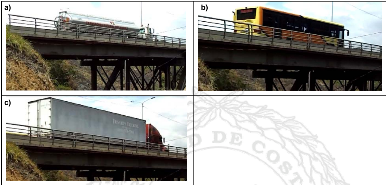
Figura 85. Acercamientos a diferentes lapsos de la medición, y fotografías de los tipos de carga asociados a algunas mediciones de deformación vertical.
