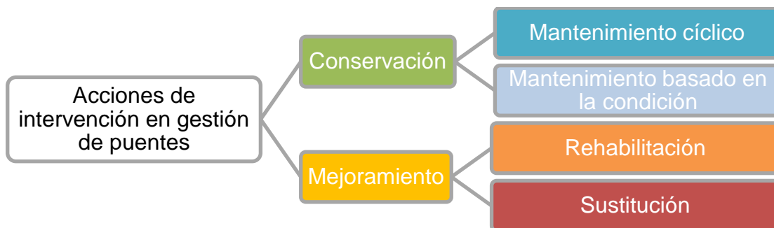
Figura 2.3. Diagrama de un programa de gestión de puentes enfocado en las acciones de intervención (Adaptado de FHWA, 2018).
