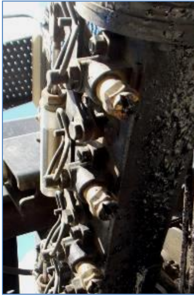
Figura 51. Boquillas del distribuidor de asfalto Fecha de la fotografía: 16-02-2018. Fuente: LanammeUCR.
