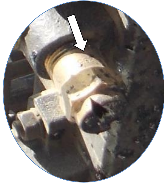
Figura 51. Boquillas del distribuidor de asfalto Fecha de la fotografía: 16-02-2018. Fuente: LanammeUCR.
