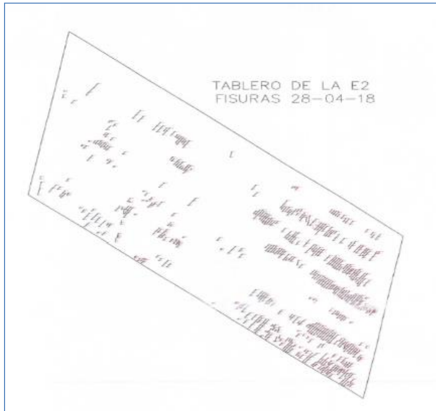
Figura 55. Levantamiento topográfico realizado por la Supervisora del agrietamiento de la losa E-2. Fuente: Unidad Ejecutora proyecto Abundancia-Florencia.
