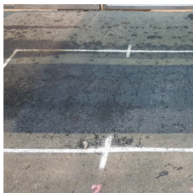
Gráfico deformación de la superficie 004AC3 1.120.000 repeticiones
