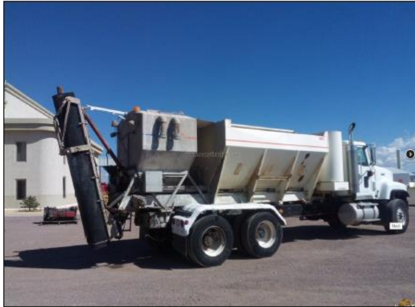
Fotografía 1: Camión distribuidor de cemento
