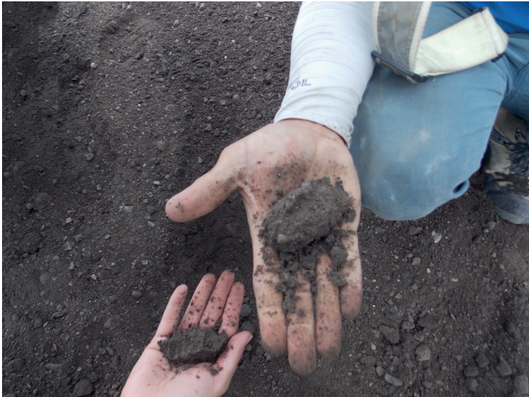
Figura 6. Prueba rápida para determinar si la humedad está en una condición cercana al óptimo Fuente: LanammeUCR
