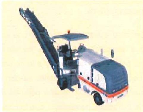
Fresadora Mecánica Tambor Wirtgen W100
