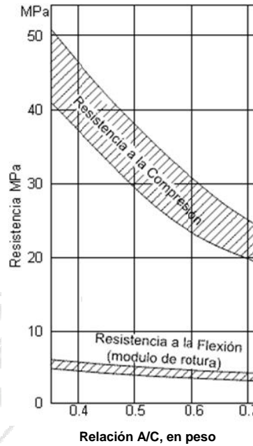
Figura 2. Efecto de la relación a/c en la resistencia a la compresión y a la flexión a los 28 días. Fuente: Mindness, 2003
