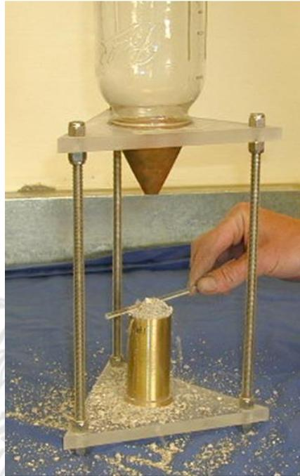
**Figura 15.** Ensayo de vacíos en finos no compactados.
