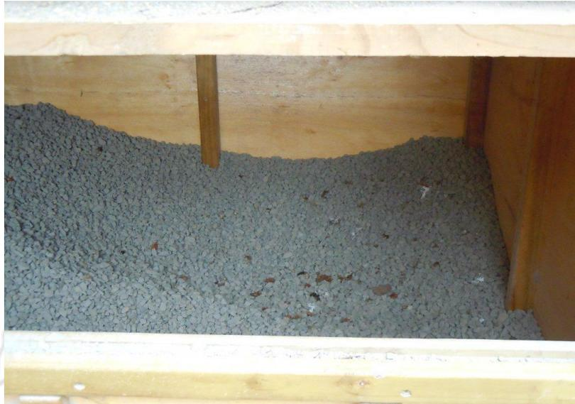
**Figura 20.** Agregado con presencia de materiales contaminantes.
