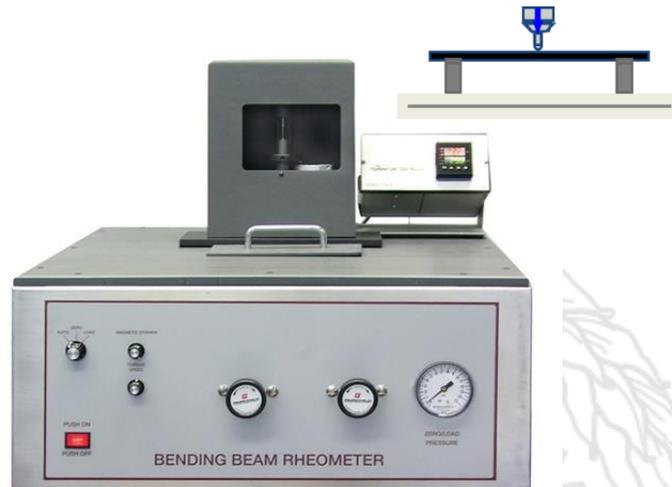
**Figura 10.** Viga a flexión (reómetro).
