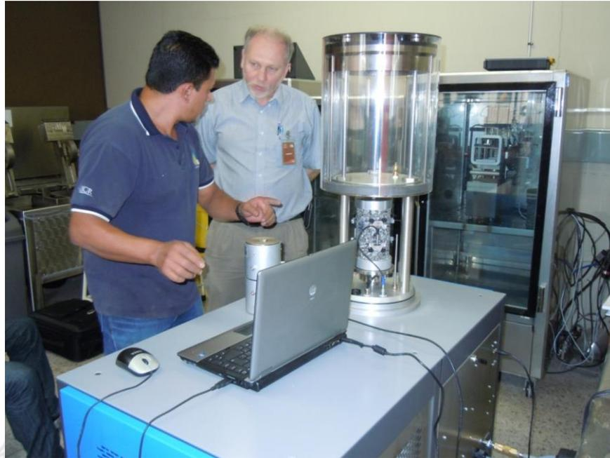
**Figura 27.** Montaje del ensayo de Módulo Dinámico.
