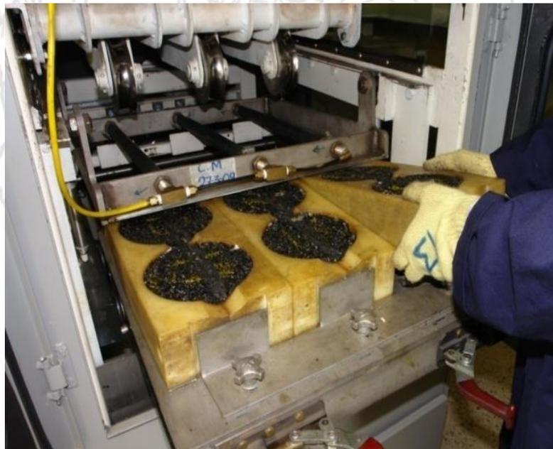
**Figura 25.** Montaje de especímenes en el Analizador de Pavimentos Asfálticos (APA).
