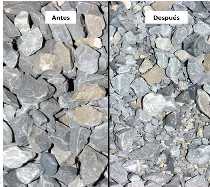
**Figura 18.** Ejemplo de agregado ensayado en la Máquina de Los Ángeles.
