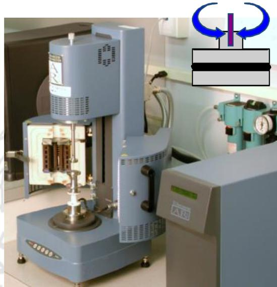
**Figura 7.** Reómetro dinámico de cortante.
