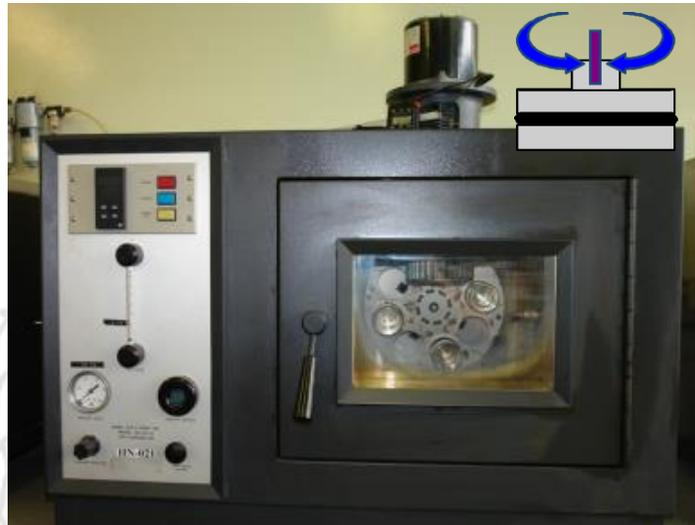
**Figura 8.** Horno rotatorio de película delgada.
