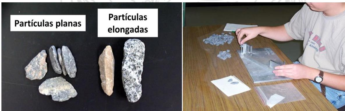
**Figura 16.** Partículas planas y elongadas en el agregado grueso.
