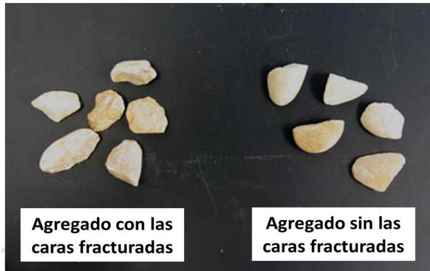
**Figura 14.** Diferencias entre caras fracturadas y sin fracturar.
