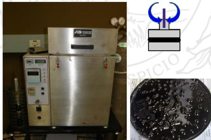
**Figura 9.** Cámara de envejecimiento a presión.
