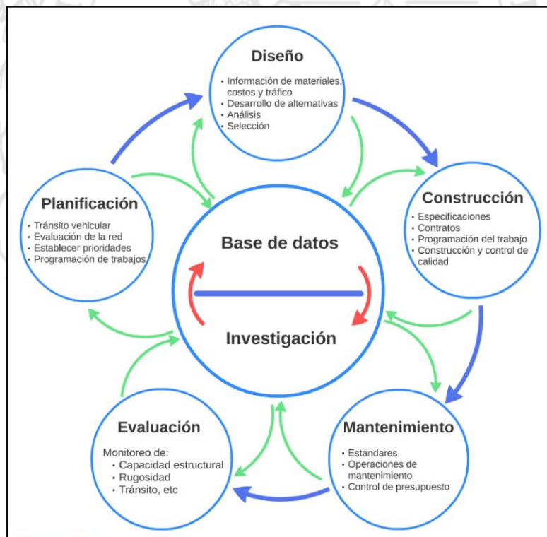
Figura 1. Estructura general de un sistema de gestión de pavimentos. Fuente: Modificado de Haas, 1993.
