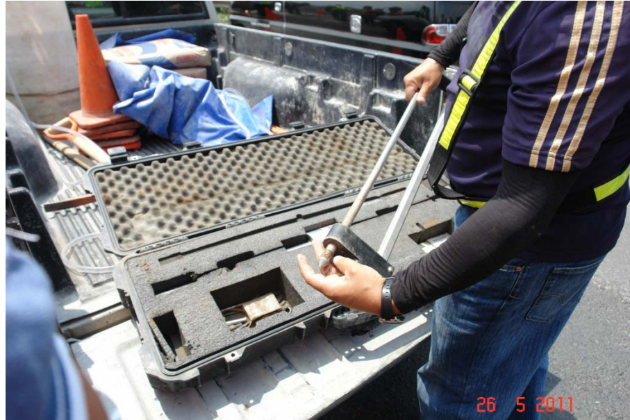
Figura 12. Kilómetro 2+650. Equipo de cono de penetración utilizado en los sondeos.
