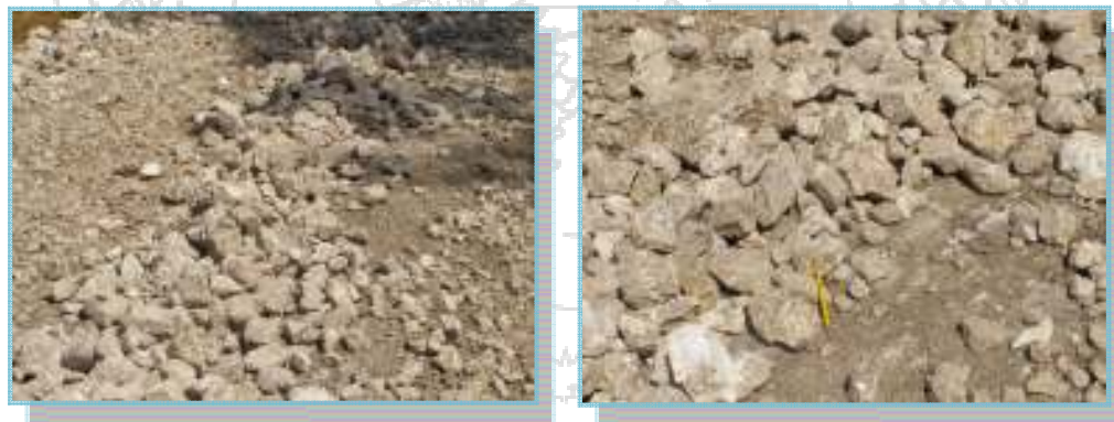
Fotografías N°2: Material calizo extraído del Tajo San Buena, con sobre-tamaño (mayor a 3 pulgadas), Estación 5+050. (Fecha de fotografía 06-May-2010)
