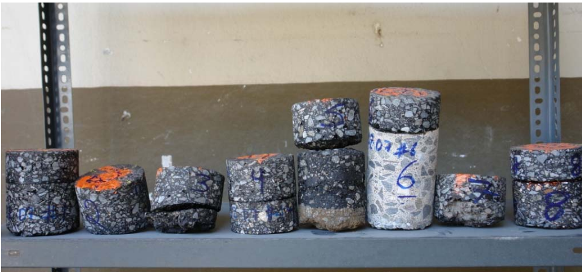
Fotografía No. 32: Muestras extraídas donde se colocó una sobrecapa en la Zona 1-7, Ruta No. 231, Sección de Control 30290.
