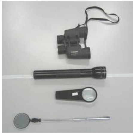
Figura 2-3 Herramientas para inspección visual
