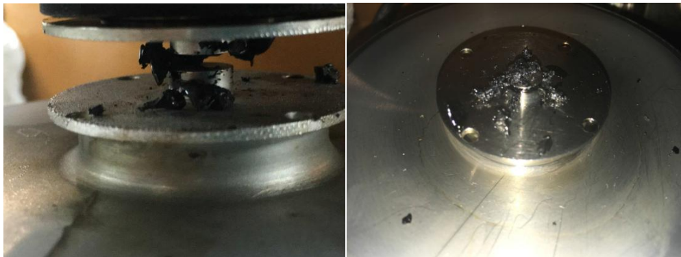
Figura 12. Muestra de asfalto fracturada luego del ensayo de Fatiga a Esfuerzo Controlado
