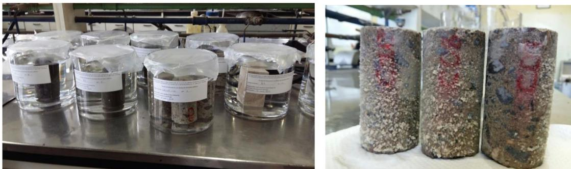
Figura 13.3. Experimento acelerado de núcleos de concreto y roca sana sometidos a disoluciones de ácido sulfúrico con diferentes grados de pH.
