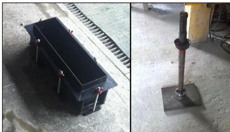
Figura 3.3. Equipo de compactación de vigas de base estabilizada con cemento.
