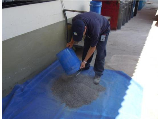
Figura 5.1. Agregado con granulometría Tipo II para los ensayos de diseño en microcapas
