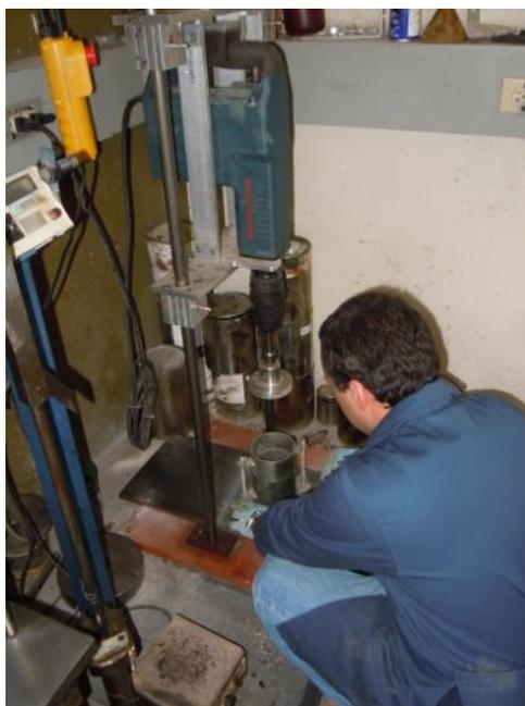
Figura 5.11. Pruebas de compactación para especímenes de Próctor Modificado
