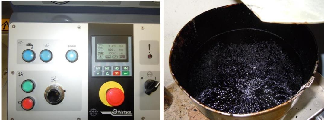
Figura 5.4. Calibración del asfalto para obtener el máximo espumado.
