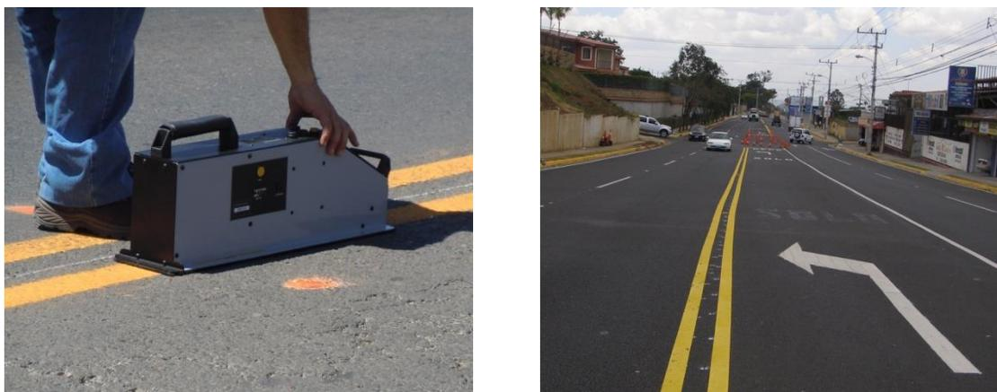
Figura 12.5. Medición de retroreflectividad en demarcación horizontal.
