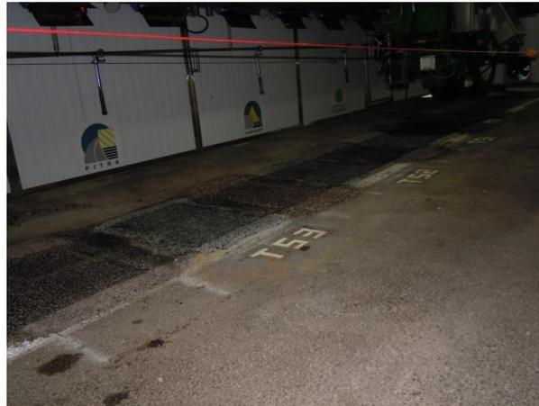
Figura 5.9. Tratamientos simples, de dos y tres capas colocados en el HVS.
