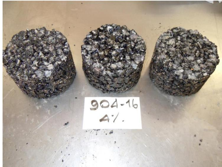
Figura 5.17. Especímenes elaborados con mezcla producida en laboratorio.
