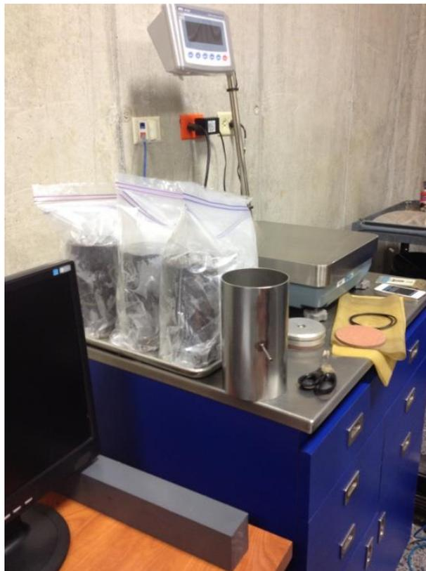
Figura 5.6. Pruebas de desempeño para determinación de la deformación permanente en el material estabilizado con emulsión asfáltica.
