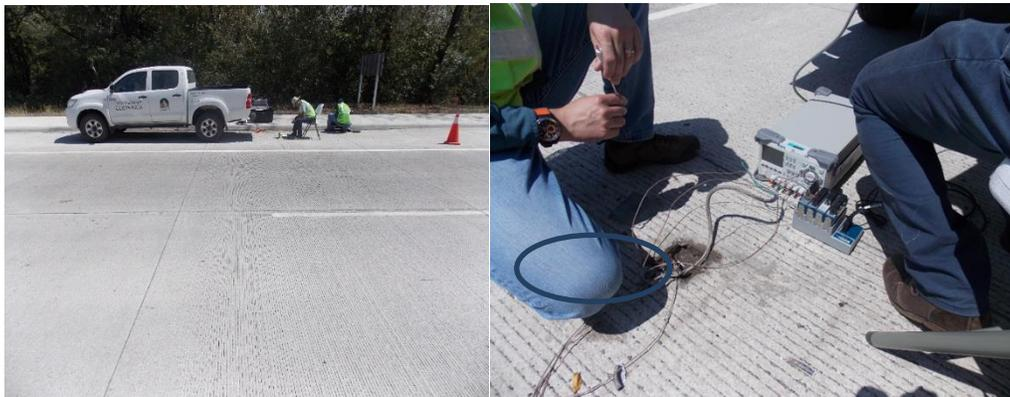
Figura 8.4. Sitio de medición y caja de acceso al cableado de la instrumentación.
