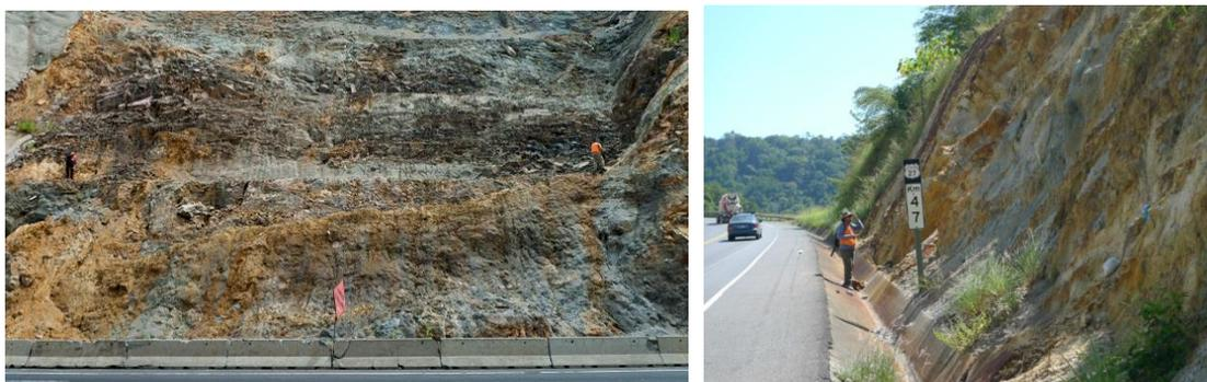
Figura 13.1. Muestreo de rocas afectadas por DAR en taludes de los estacionamientos 45 y 47 de la Ruta Nacional 27
