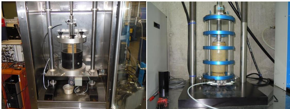
Figura 5.5. Ensayos de caracterización para estabilización de bases granulares asfalto espumado, Módulo resiliente y triaxial
