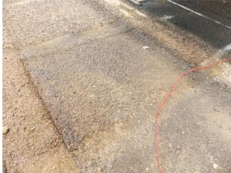
Figura 5.15. Bache evaluado en el Simulador de Vehículos Pesados (HVS).
