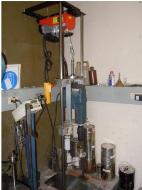
Figura 5.10. Compactador vibratorio instalado en el laboratorio.
