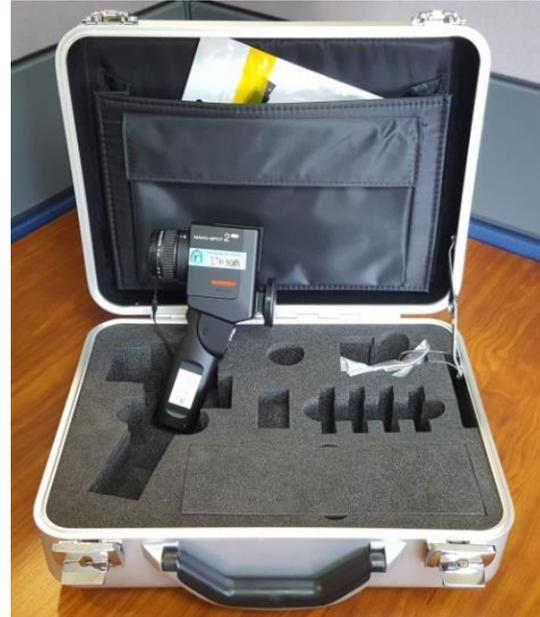
Figura 12.11. Equipo para la medición de la luminancia.
