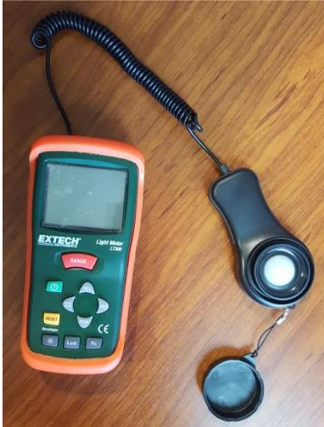
Figura 12.10. Equipo para la medición de la iluminancia.
