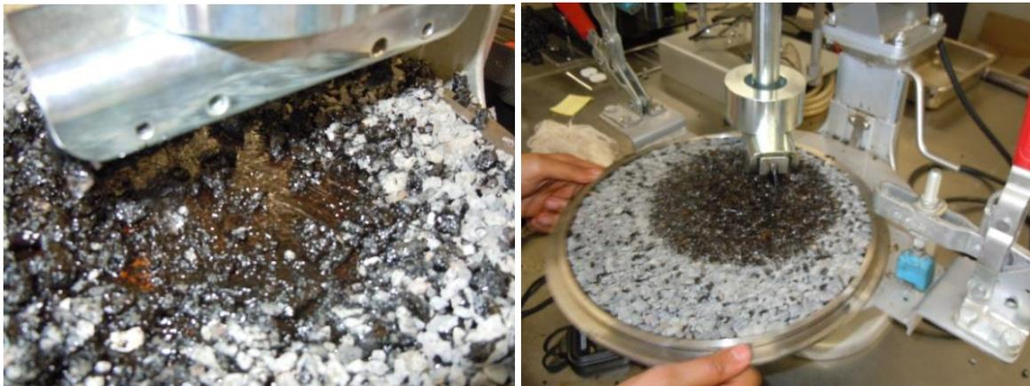
Figura 5.7. Pruebas de barrido en tratamientos superficiales con emulsiones diferentes
