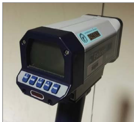
Figura 2. Radar manual del LanammeUCR para elaboración de perfiles de velocidad
