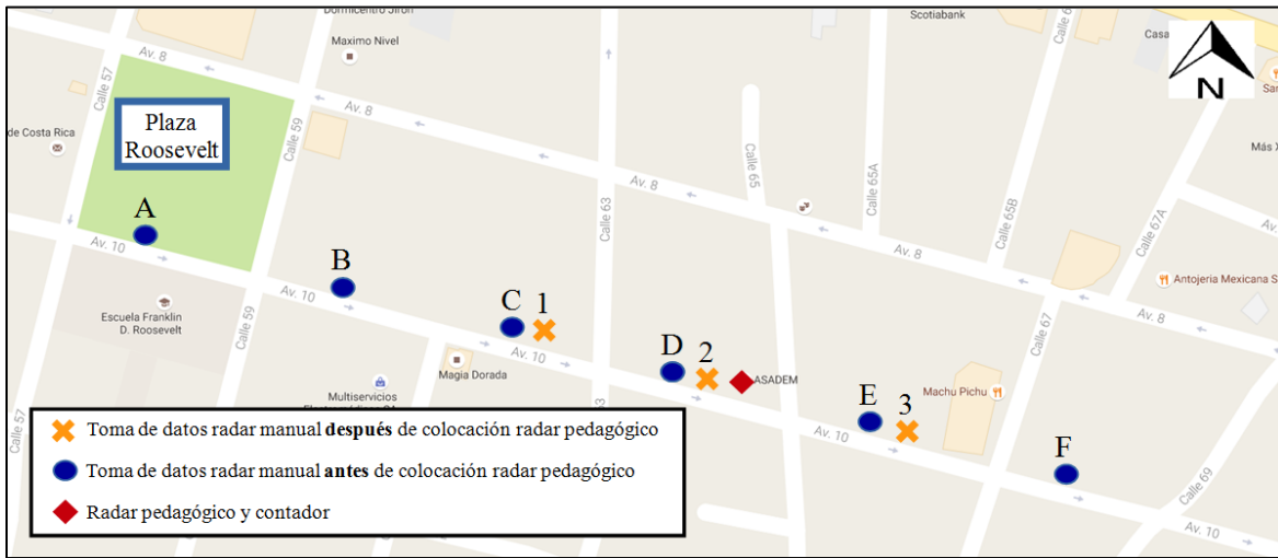
Figura 7. Ubicación de los puntos de toma de datos con el radar manual y de colocación del radar pedagógico y el contador neumático
