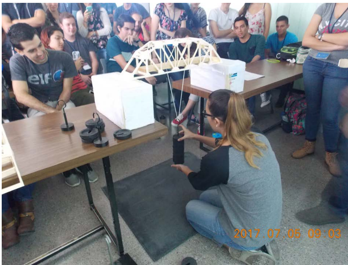
Figura 1. Estudiantes de ingeniería civil determinando la capacidad estructural de un puente tipo armadura fabricado con cartón de manila
