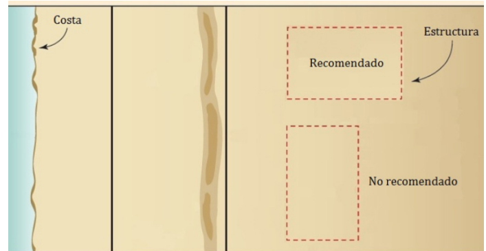
Figura 7. Orientación recomendada y no recomendada de una estructura al considerar el área expuesta
