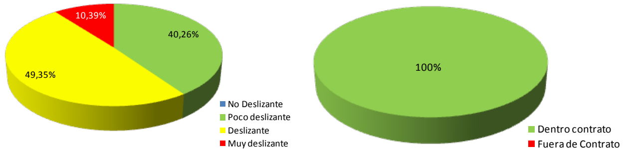
Figura 9: Resultados de las pruebas de Grip Tester (izquierda) y Mu Meter (derecha), para el sentido Caldera - San José en la Ruta 27. Los rangos dados para el Mu Meter corresponden a los indicados en contrato.
