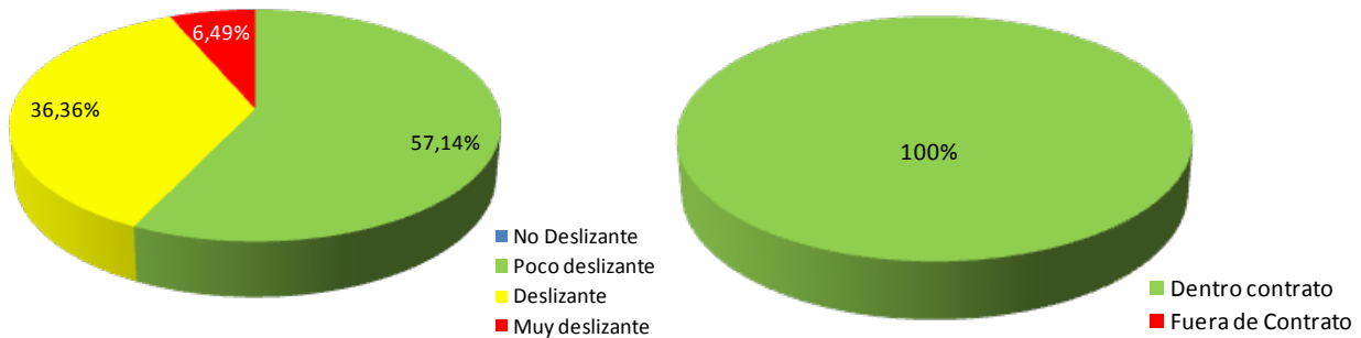
Figura 8: Resultados de las pruebas de Grip Tester (izquierda) y Mu Meter (derecha), para el carril en el sentido San José - Caldera Ruta 27. Los rangos dados para el Mu Meter corresponden a los indicados en contrato.
