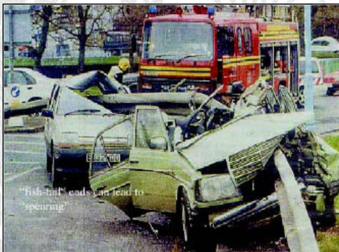
Figura 4. Ejemplo del peligro de un diseño de terminal inadecuado para un SCV.
