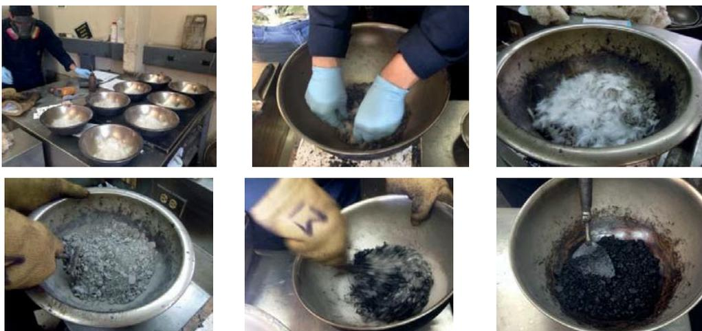
Figura 4 Procedimiento de adición de la fibra en la mezcla asfáltica en laboratorio
