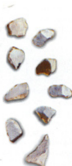
Figura 3: Acción de una emulsión aniónica con un material calizo.
