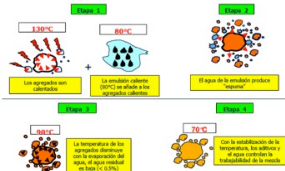
Figura 8 Proceso de mezclado utilizando emulsiones. Referencia 4.
