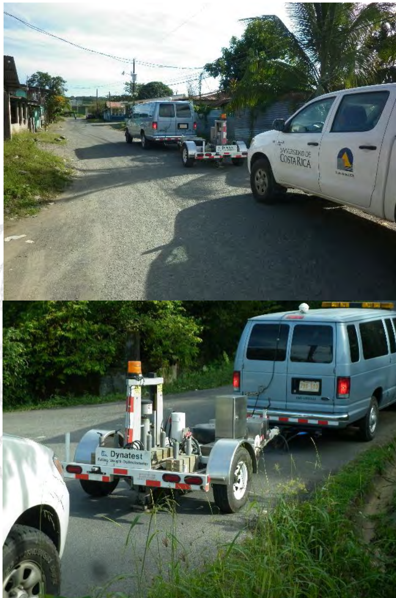
Figura 7. Ensayo de deflectometría de impacto (FWD) efectuado en Limoncito.
