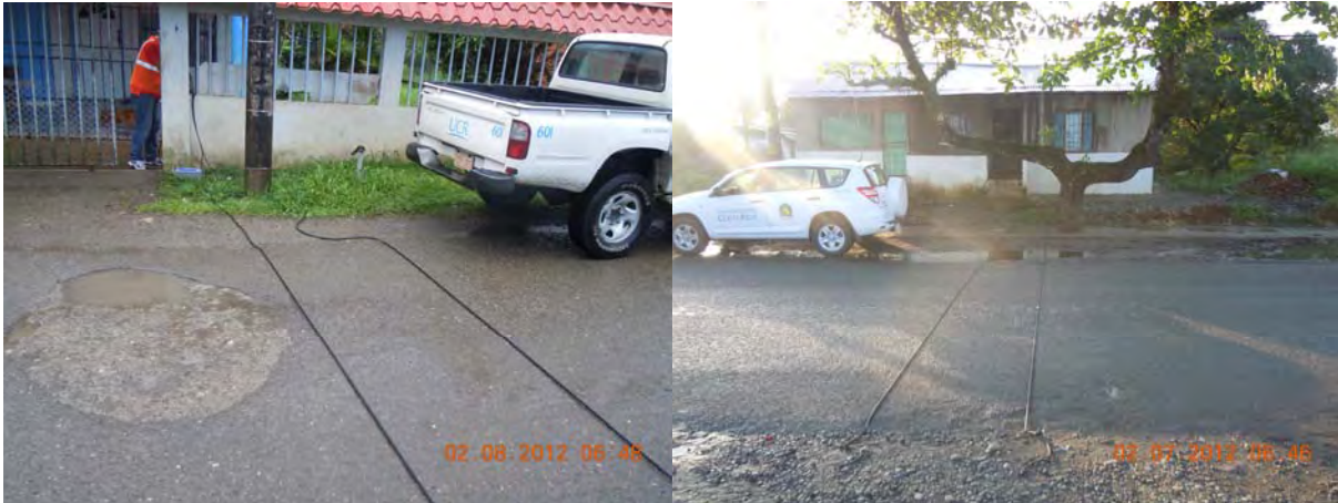
Figura 13. Colocación del equipo de conteo vehicular en diferentes puntos de Limoncito.
