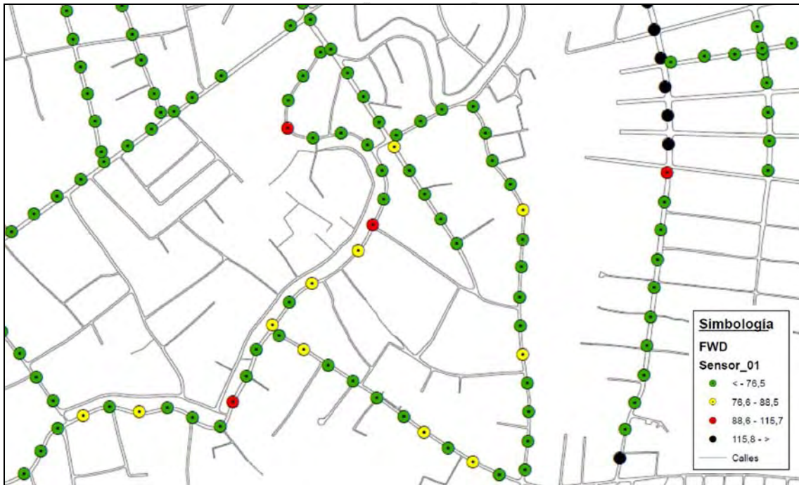
Figura 8. Acercamiento del mapa de deflectometría de impacto (FWD).
