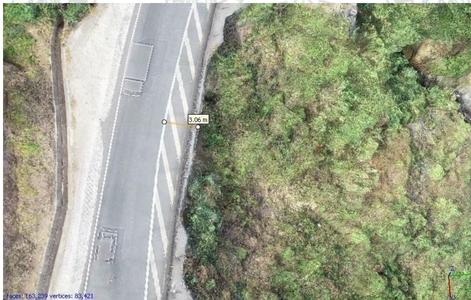
Fotografía No.5: Vista en planta de la sección en uso. La distancia horizontal entre el tránsito vehicular y el borde del deslizamiento es de
