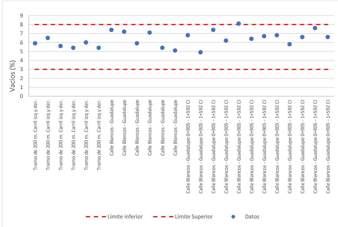
Figura 66. Resultados obtenidos por el LanammeUCR para el porcentaje de vacíos en el sitio de la mezcla asfáltica en caliente colocada en el proyecto(núcleos).
