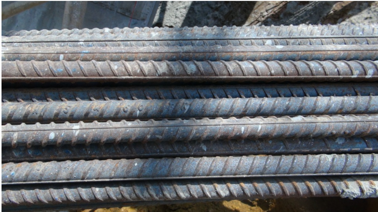
Figura 7: Paso a desnivel 1+551:La procedencia del acero de refuerzo es Turquía y Costa Rica.
