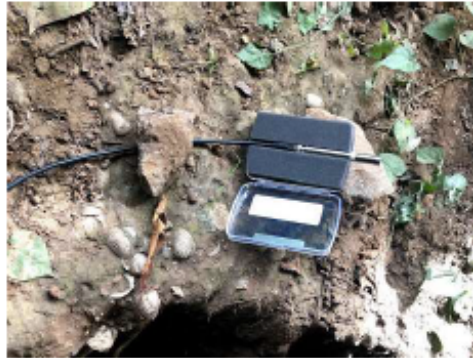
Figura 10. Micrófonos colocados debajo del puente sobre el Río Desjarretado.
