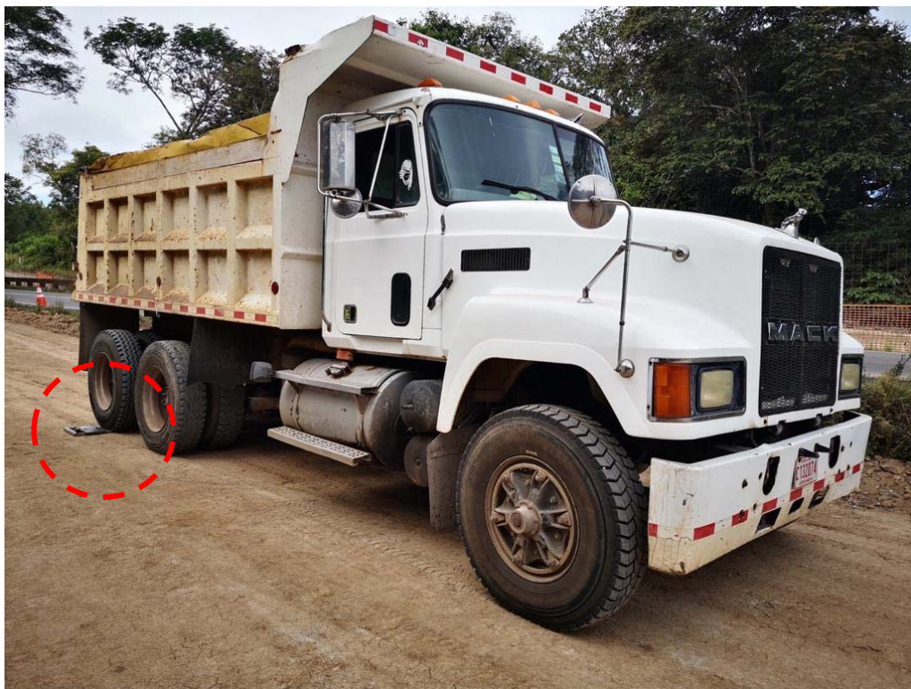
Figura 5. Pesaje de vagoneta cargada contratada para transitar por el puente.
