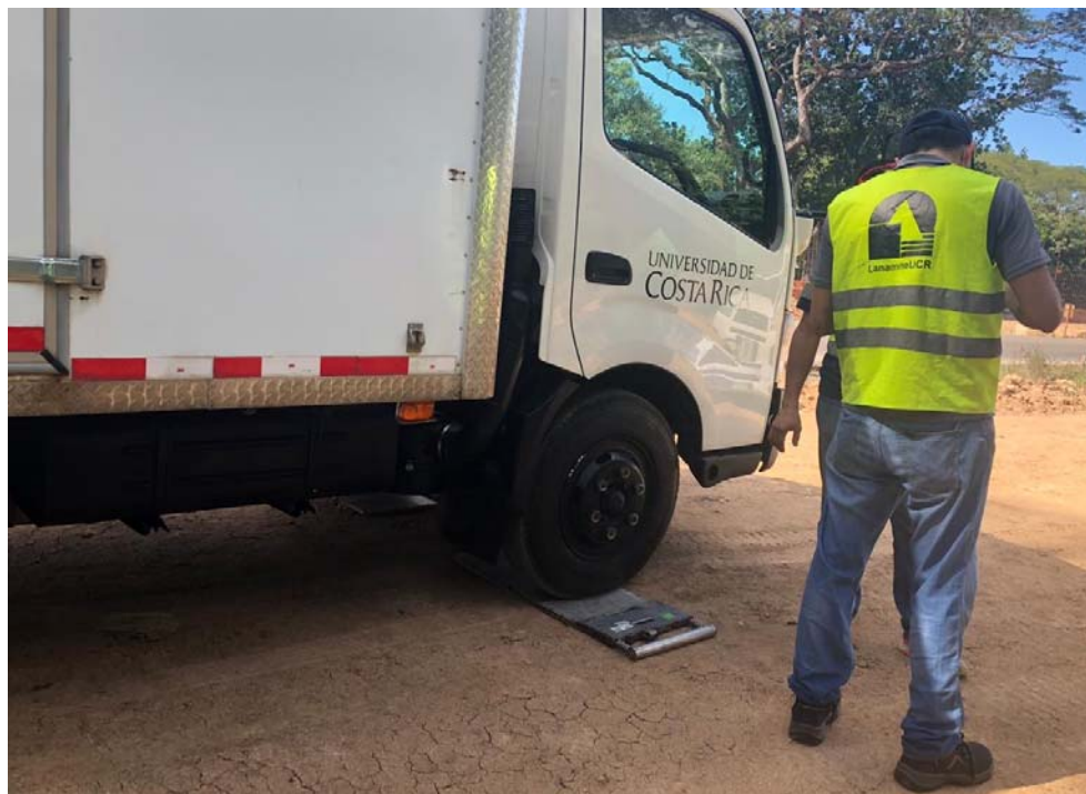
Figura 3. Pesaje de camión del LanammeUCR.
