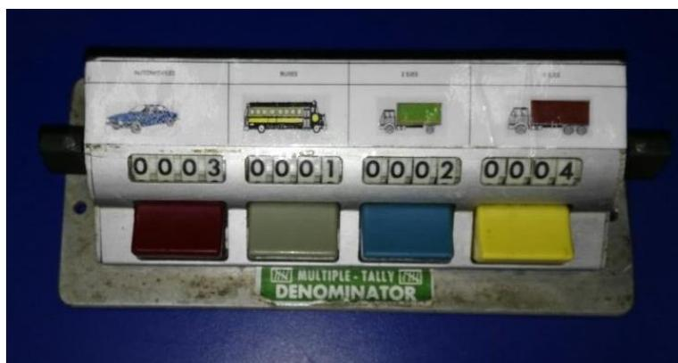
Figura 1. Ejemplo de contador manual con cuatro tipos de vehículo.
