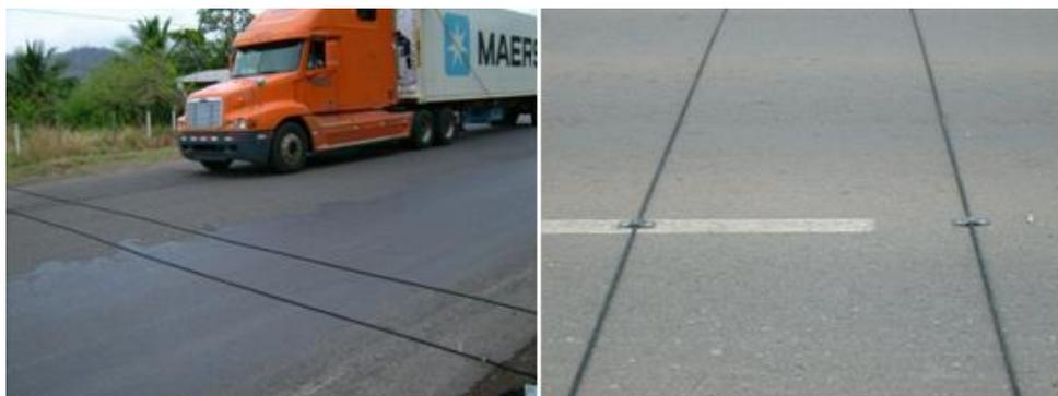
Figura 3. Ejemplo de contador de mangueras en sitio.
