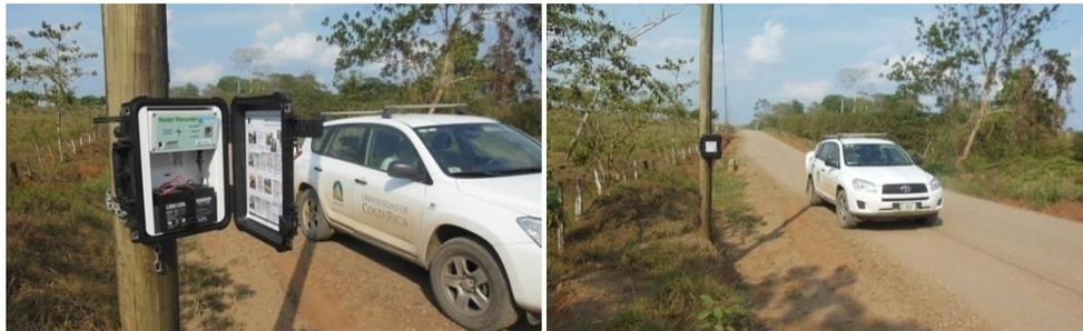
Figura 2. Ejemplo de contador de radar en sitio.
