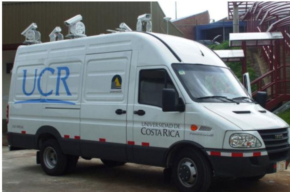
Figura 1 Equipo de Auscultación Visual con Imágenes Digitales Georreferenciadas
