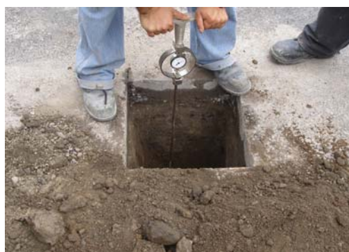
Figura 28. Prueba de CBR en sitio (Fuente: LanammeUCR, 2008).
