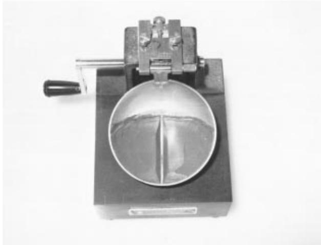
**Fig. 1 Surco formado en la pasta de suelo en el dispositivo de límite líquido**
